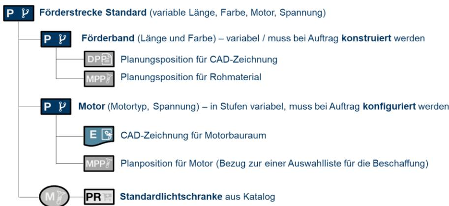
Abbildung 2 Produktvariantenstruktur eines Anlagenbauers für Gepäckförderanlagen
